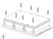
付属の木ネジでスペーサーと ディフューザーを同時に固定する
